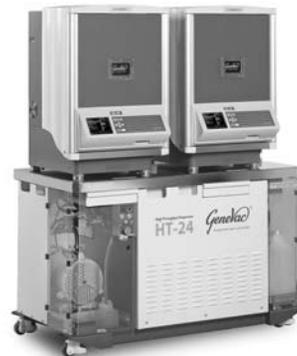
et rapide. Le système Dri-Pure® incorporé à l'évaporateur empêche les éjections (Ang. « bumping ») et la contamination croisée ; le logiciel intégré contrôle et affiche les pressions et les températures des échantillons. La température est mesurée avec un thermocouple placé dans le support d'échantillons, un autre thermocouple peut être introduit dans l'échantillon pour fournir une information supplémentaire sur le procédé d'évaporation.
